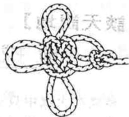
此結可套在桅杆頂部，用作臨時固定桅杆之用。結的三個圈套分別連上 FORESTAY (一條) 和 SHROUD (兩條)。此外，本結亦可用為瓶口結，在緊套瓶口或袋口後，更有四個圈套作為提手，方便數人搬運。
